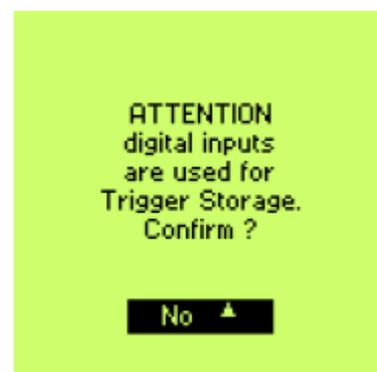
Параметр, выбранный в меню TYPE цифровых входов, будет приемлемым только в том случае, если дано подтверждение на сброс счетчиков.
