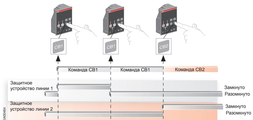
Рисунок 4.3 Управление в Ручном режиме
