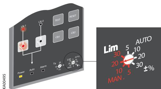
Рисунок 4.1 Перевод блока ABP ATS021 в ручной режим
