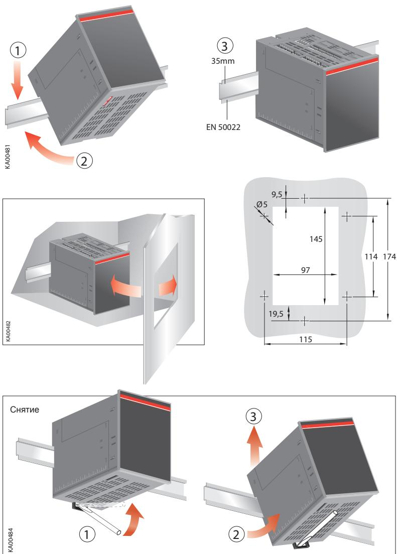
Рисунок 5.4      Блок АВР ATS021 с креплением на дин-рейку
