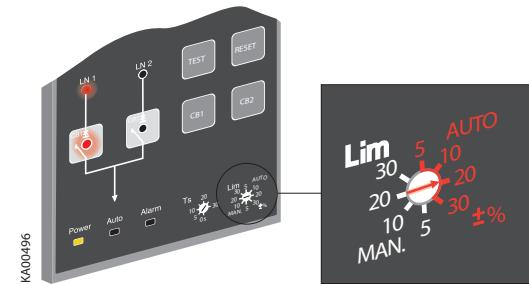
Рисунок 4.4 Перевод блока АВР ATS021 в Автоматический режим
