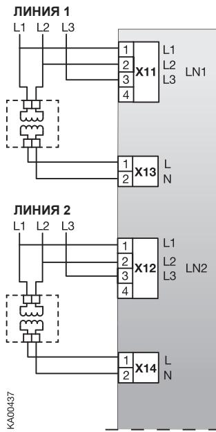
Рисунок 2.5 При использовании ATS021 без нейтрали необходим внешний трансформатор.
