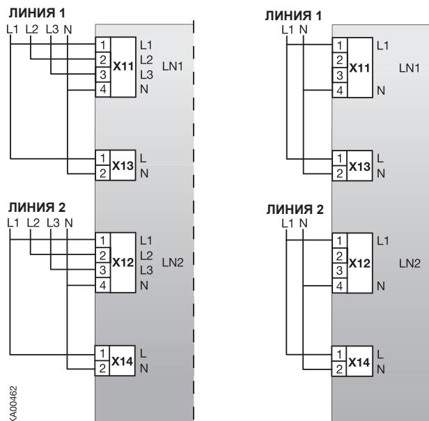
Рисунок 2.4 ATS021 может контролировать как две трёхфазные, так и две однофазные линии питания.
