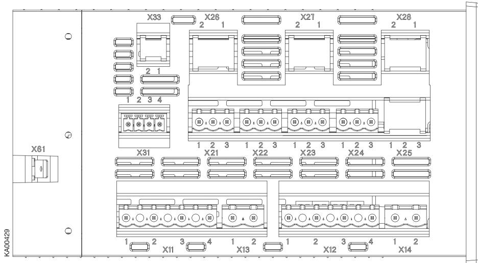
Рисунок 6.4 Клеммы, ATS021
