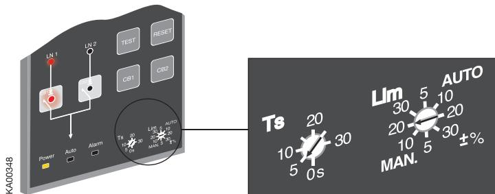
Рисунок 4.5 Настройка времени задержки и порогового напряжения на блоке ATS021
