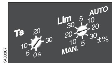
Рисунок 7.2      Выбор времени задержки и порога напряжения. Заводские настройки показаны на рисунке
