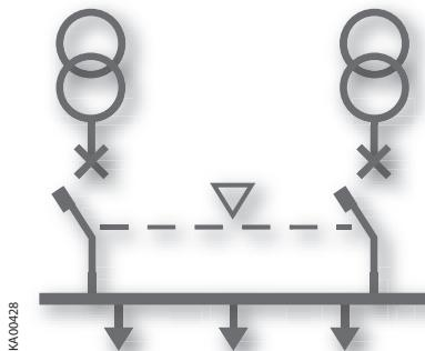
Рисунок 2.2 Трансформаторная линия a - Трансформаторная линия b
