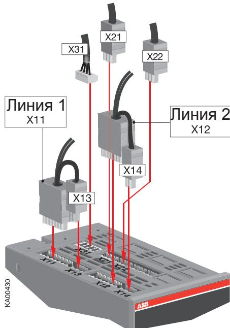
Рисунок 6.2 Подключение цепей управления ATS021
