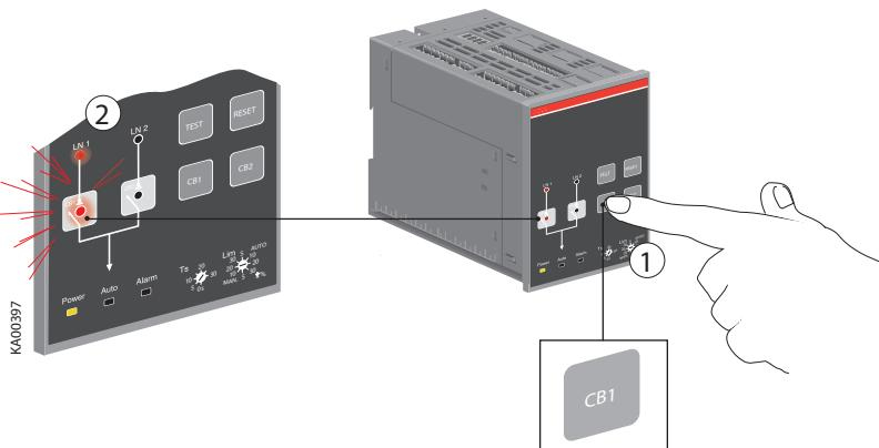
Рисунок 4.2 Выбрав рабочую линию, состояние выключателя и выбранной линии отображается с помощью светодиодов блока ATS021
