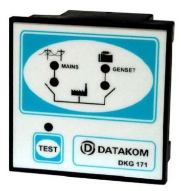
Модуль DATAKOM DKG-171 является надежным микропроцессорным устройством, предназначенным автоматизации ввода резерва (АВР). Модуль производит контроль состояния параметров сети (наличие напряжения), управляет переключением контакторов сети и генератора, а также управляет запуском резервного электрогенератора путем подачи сигнала дистанционного запуска (для панелей функцией управления дистанционного управления).
