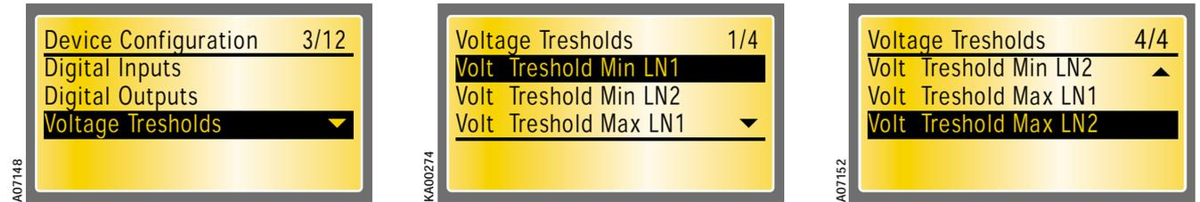
Рис. 11.30. Значения порогов напряжения (минимальный и максимальный) для линии 1 и линии 2
