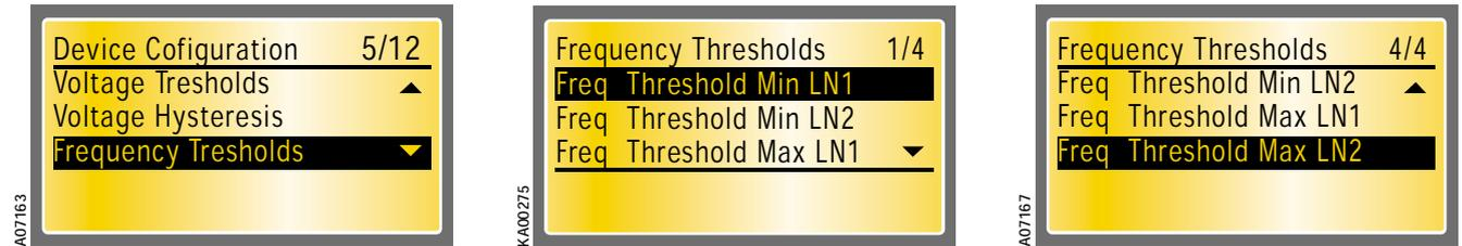
Рис. 11.35. Значения порогов частоты (минимальный и максимальный) для линии 1 и линии 2
