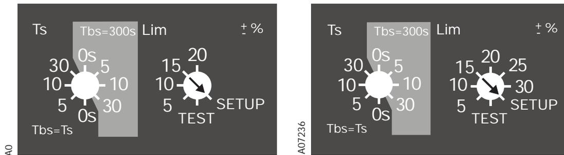
Рис. 4.9. Выбор режима SETUP (НАСТРОЙКА) с помощью поворотного переключателя Lim в блоках автоматического управления OMD100 (слева), OMD200 и OMD300 (справа)
