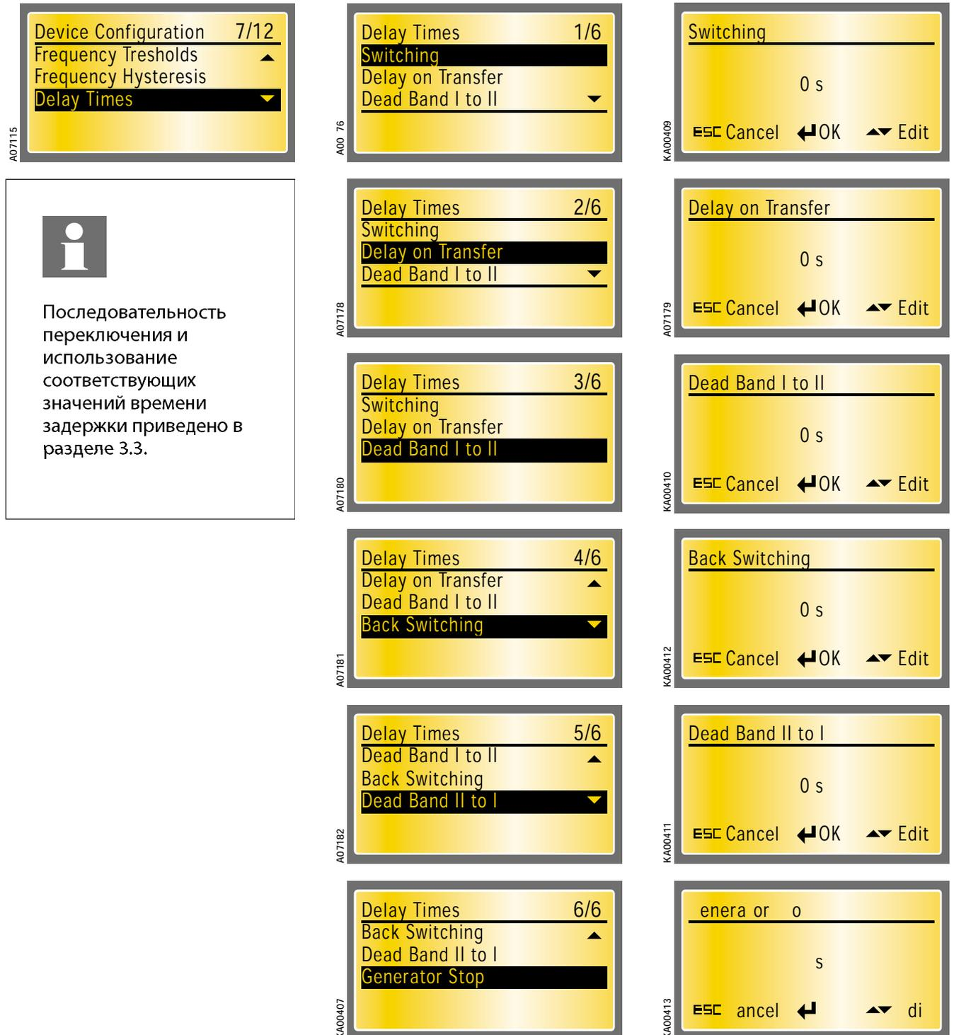
Рис. 11.40. Switching (Переключение) — 0 с (с), Delay on Transfer (Задержка включения резерва) — 0 с (с), Dead Band I to II (Мертвая зона переключения I-II) — 0 с (с), Back Switching (Обратное переключение) — 0 с (с), Dead Band II to I (Мертвая зона переключения II-I) — 0 с (с), Generator Stop (Останов генератора) — 5 с (с)
