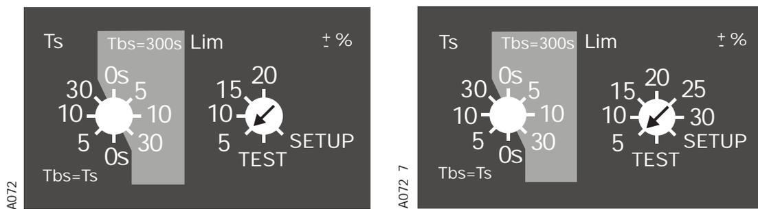
Рис. 7.14. Выбор режима SETUP (НАСТРОЙКА) с помощью поворотного переключателя Lim в блоках автоматического управления OMD100 (слева), OMD200 и OMD300 (справа)
