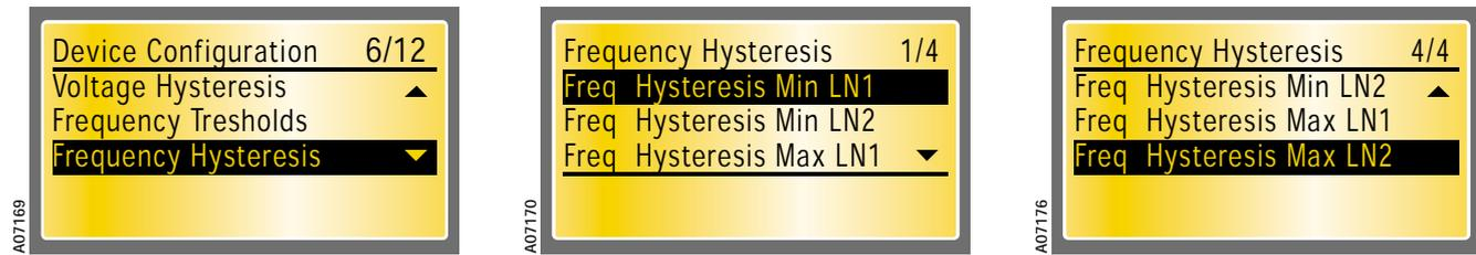
Рис. 11.37. Значения гистерезиса частоты (минимальный и максимальный) для линии 1 и линии 2
