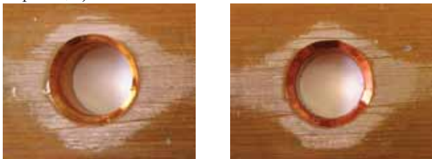
Рис. 8. Эффективная площадь контактирования РЭКС, состоящего из двух медных шин
