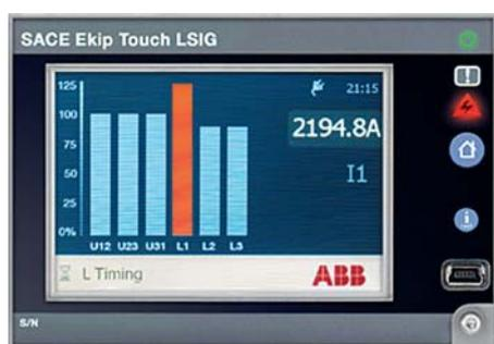
Кроме того, можно выбрать в качестве страницы по умолчанию гистограммы, показывающие токи трех фаз и нейтрали на шкале 0-125% In, в дополнение к числовому значению наиболее нагруженной фазы. Для быстрого и четкого определения сбоев используются гистограммы желтого цвета в случае предаварийной сигнализации и красного в случае перегрузки.
