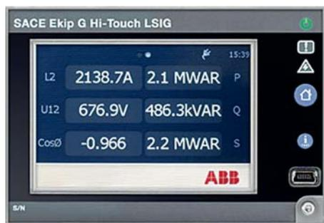
Все операции Ekip Touch просты и интуитивно понятны благодаря широкому графическому сенсорному цветному дисплею. Например, вся основная информация приводится на одной главной странице (устанавливается по умолчанию), что позволяет быстро определить состояние установки: максимальный ток, максимальное напряжение, активная, реактивная, полная мощность и энергия.
