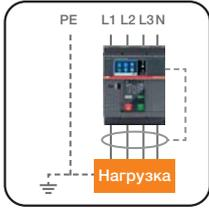
**Защита от тока утечки (Rc – ANSI 64 и 50NDT):** с постоянным временем срабатывания ( $t = k$ ), защищает от косвенного прикосновения и интегрирована в устройство Ekip Touch с помощью специального модуля номинального тока и внешнего датчика тока утечки на землю Rc. Защита является альтернативой функциям G и Gext.
