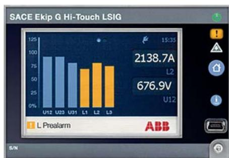
На передней панели расцепителя имеется также два светодиода: светодиод предварительной сигнализации (квадратный желтый светодиод) и аварийной сигнализации (красный треугольный светодиод); сообщение на дисплее всегда сопровождается миганием светодиодов для четкой идентификации типа события. Список всех активных на данный момент сигналов тревоги можно просмотреть, просто коснувшись надписи на белой полосе на дисплее в нижней левой части зоны аварийной сигнализации.
