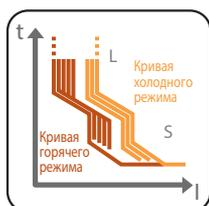
**Тепловая память:** для функций защиты L и S, используется для защиты таких устройств, как трансформаторы, от перегрева вследствие перегрузки. Функция, которую можно активировать с помощью программного обеспечения Ekip Connect, регулирует время защитного срабатывания согласно времени, прошедшему с момента первой перегрузки, принимая во внимание количество произведенного тепла.
