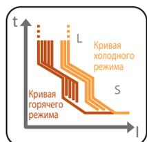
**Тепловая память:** для функций защиты L и S, используется для защиты таких устройств, как трансформаторы, от перегрева вследствие перегрузки. Защита регулирует время срабатывания защиты в соответствии с тем, сколько времени прошло после первой перегрузки, с учетом произведённого тепла.
