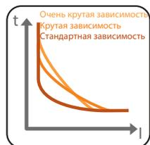
**Защита от перегрузки (L - ANSI 49):** имеется с тремя различными типами кривых срабатывания:
