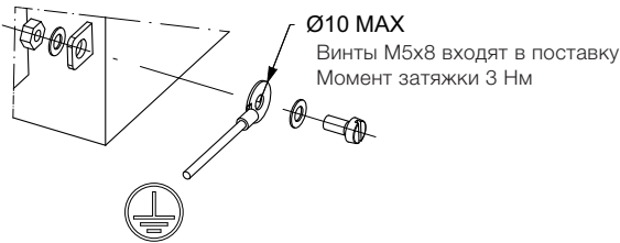
Устройство заземления FA2 - FA4
