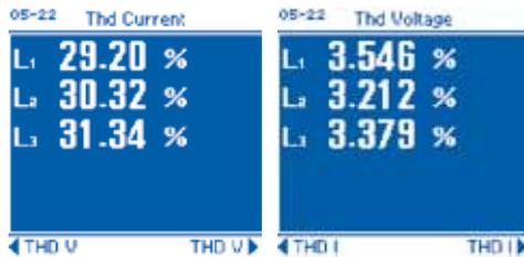
Рис. 7. Отображение суммарных коэффициентов гармонических составляющих напряжений и токов (в процентах)
