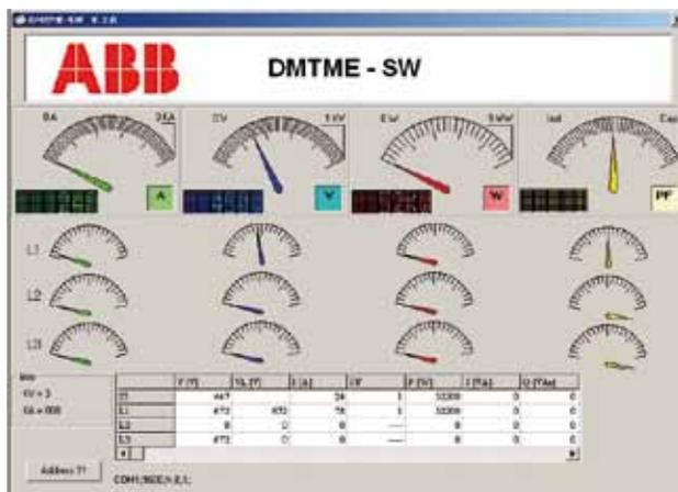
Рис. 15. Окно программы DMTME-SW, отображающее значения, полученные из нескольких мультиметров
