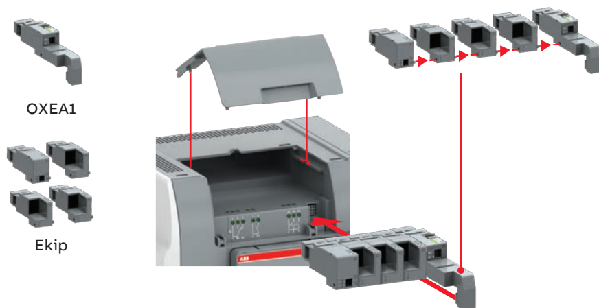
Рис. 9.6 Монтаж модуля вспомогательного питания OXEA1 и модулей Ekip
