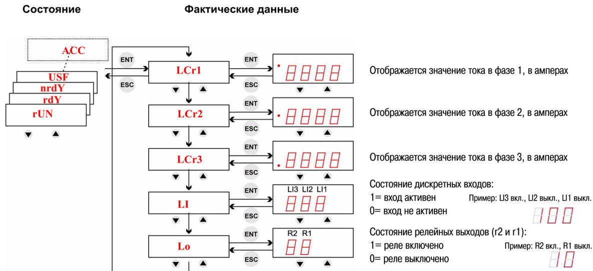
**Примечание:** Если устройство ATS22 включено в обмотки двигателя, соединенные треугольником, значения LCr1, LCr2, LCr3 являются фазными токами. При этом линейный ток определяется:  $LCr \times \sqrt{3}$
