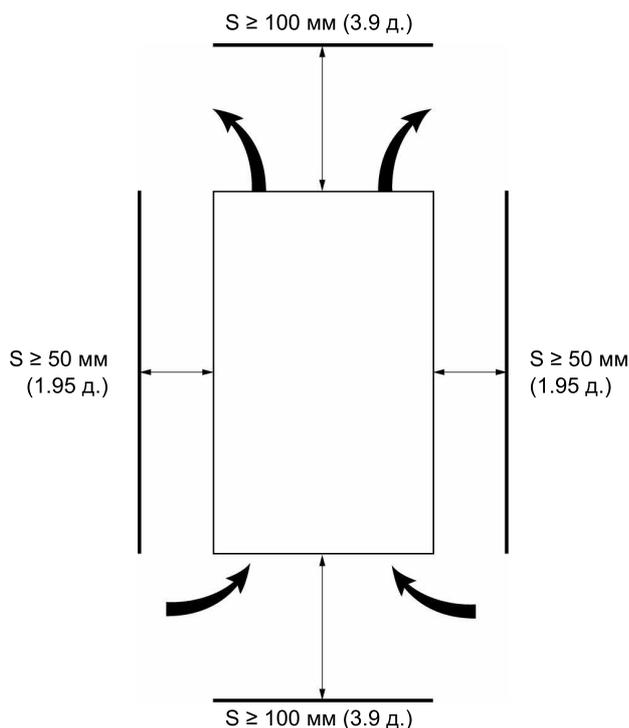
**Примечание:** При установке устройств рядом, свободное пространство между ними должно быть  $\geq 50 \text{ мм (1.95 д.)}$
