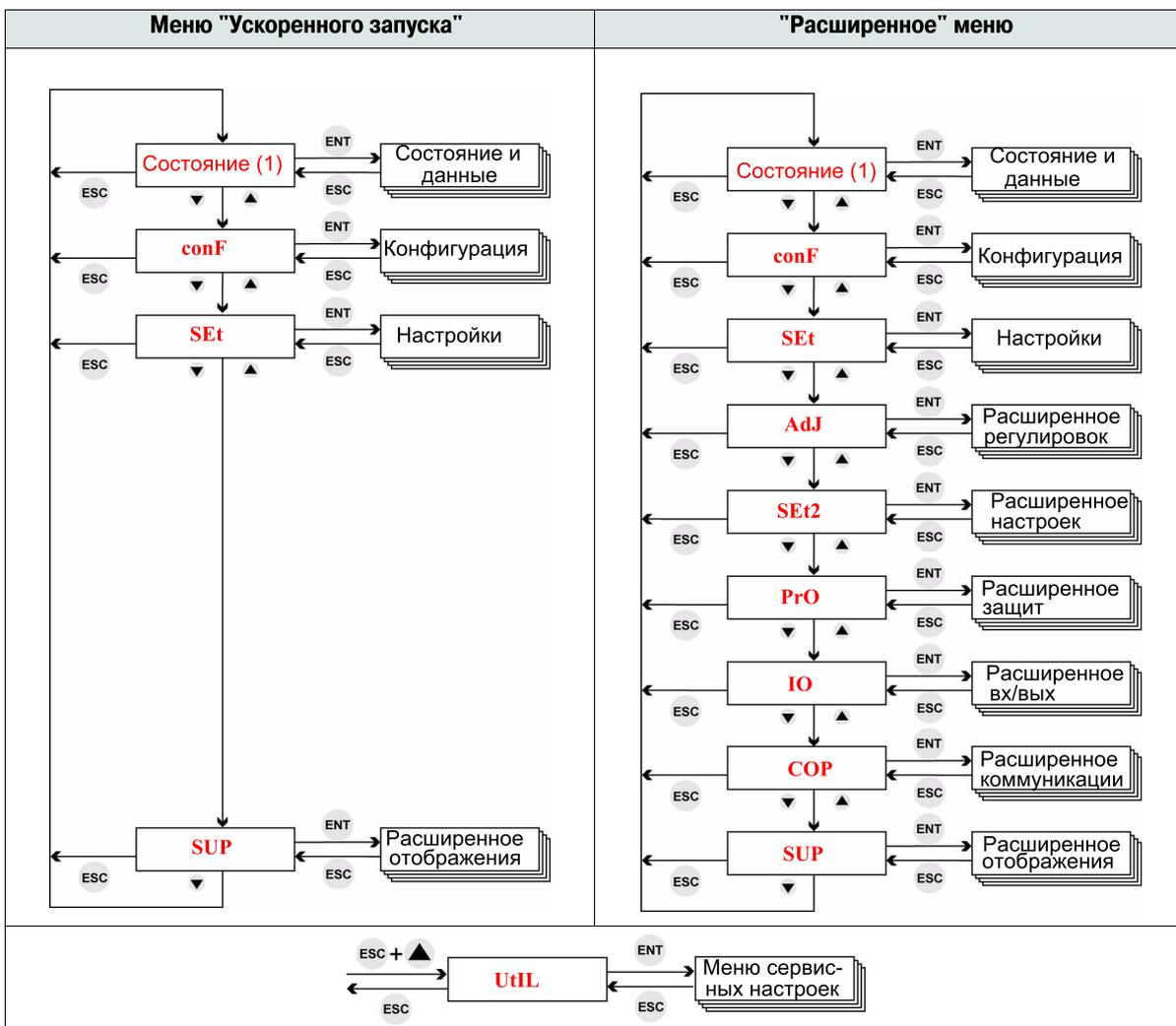
(1) На дисплее отображается фактическое состояние устройства ATS22: **rdY**, **nrдY**, **rUn**
