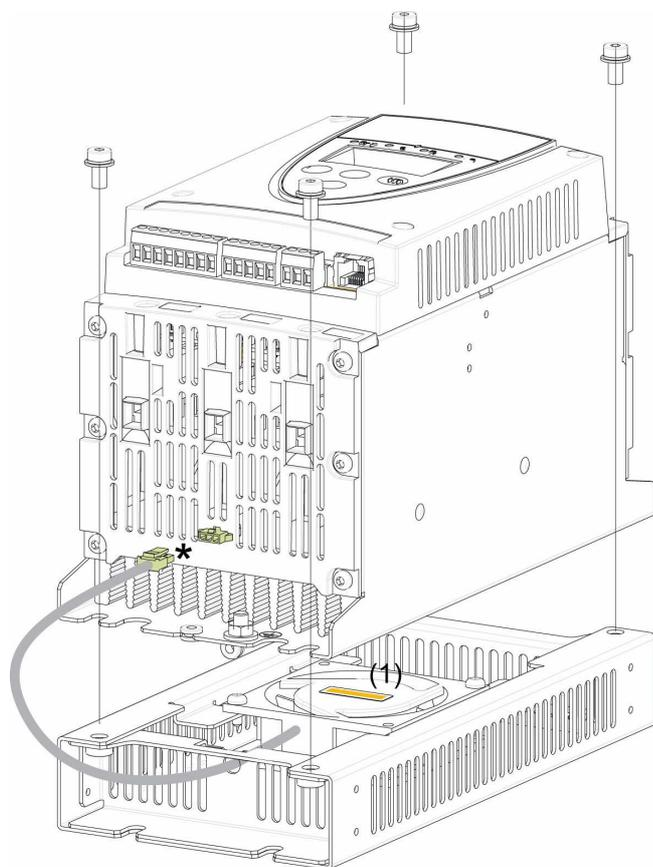
Момент затяжки: 3.5 Нм (31 фунт\*дюйм)
