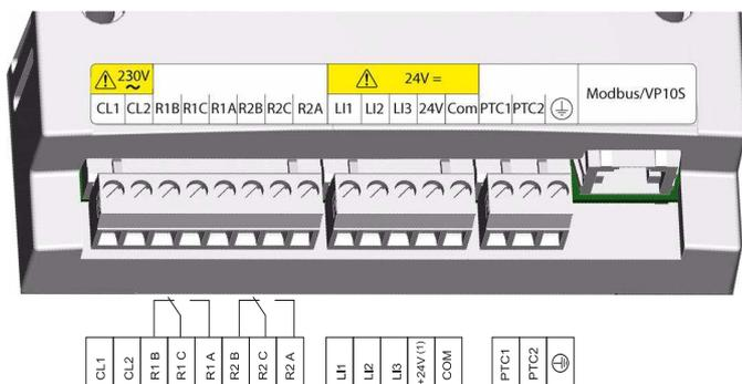
К разъемам цепей управления устройства ATS22 присоединяются съемные клеммники с защитой от неправильного подключения.
