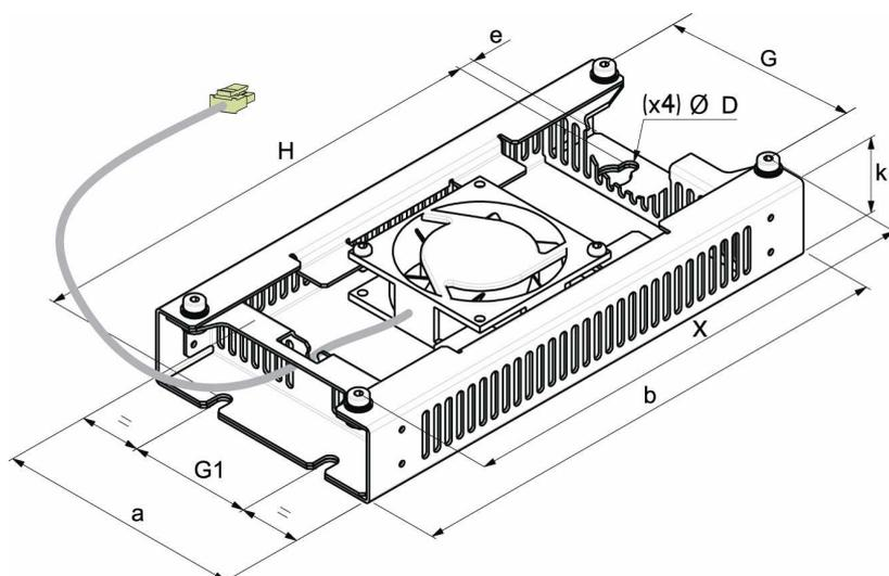
Для типоразмеров устройства ATS22 с D17 по C17 вентилятор заказывается отдельно (1)
