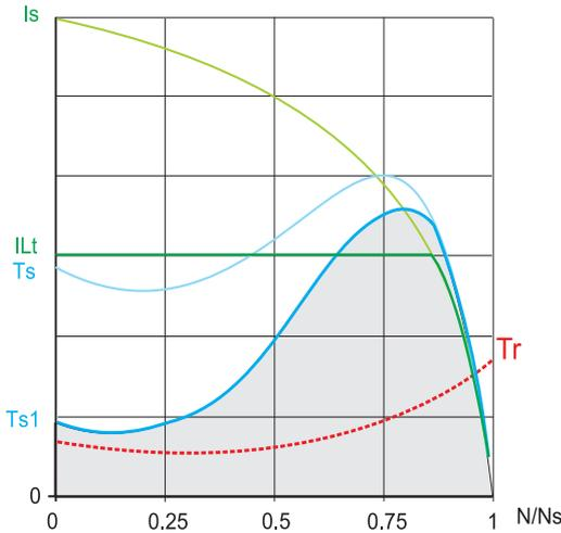
**Ts и Is:** Прямой пуск асинхронного электродвигателя от сети
