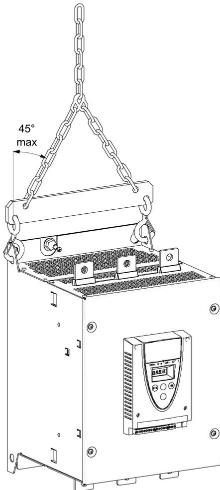
Не извлекайте устройство ATS22 из упаковки до его доставки к месту монтажа. После извлечения устройства Altistart 22 из упаковки перемещайте его осторожно во избежание повреждения электронных компонентов, рамы или оболочки. Устройство ATS 22 может перемещаться:
